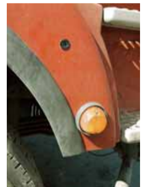
Slik ser sensorene til blindfeltradaren ut. (Foto: Kjell Wold)
